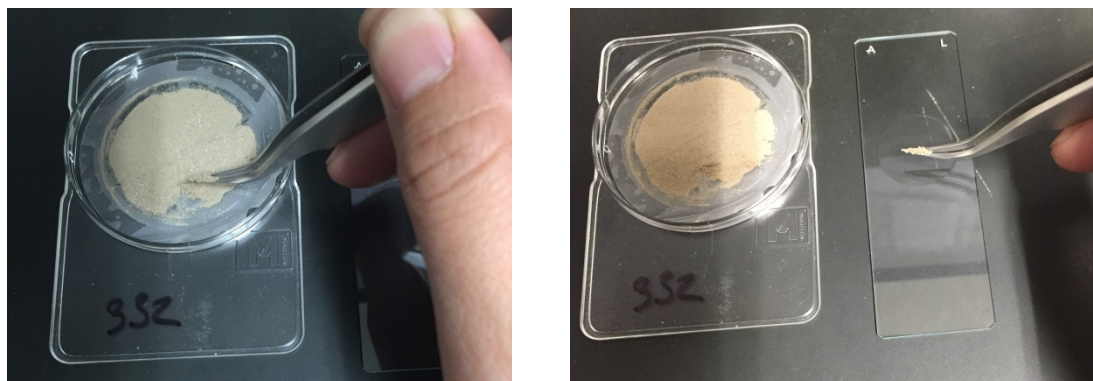
図 6.1 ポリカーボネートフィルタ上の残渣からの ポイントカウント用プレパラートの作製
