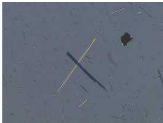
写真 5. クロシドライトの多色性。右上がりの対角位では明るくなるが、左上がりの対角位では暗青色になる。
