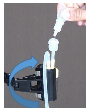
図 53 直径 13 mmフィルターを使用した場合の蛍光染色方法
